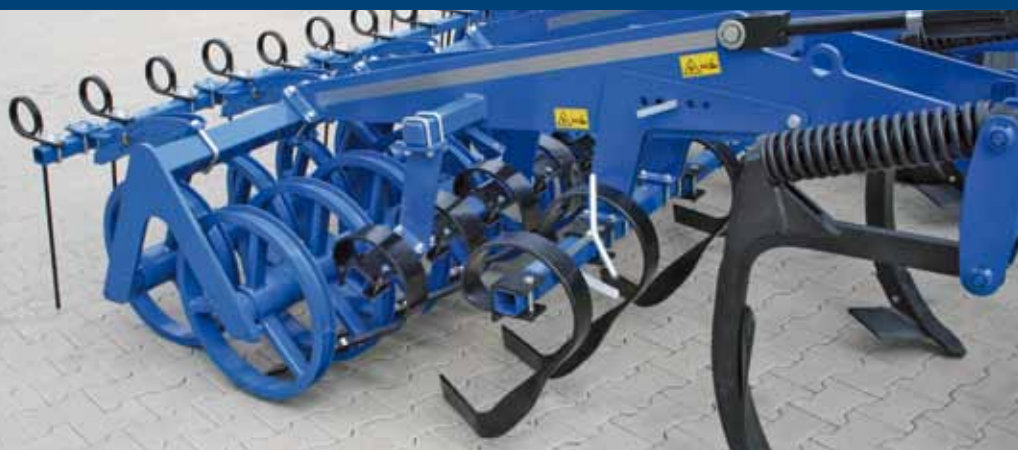
Für optimale Einebnung: Nivellator, Crossboard, Doppel-STS-Walze und Nachstriegel
