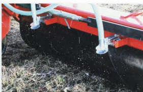
Levityslautaset hajottavat siemenen tasaisesti. Tuulen vaikutus levitystasaisuuteen on olematon, ainakin keskikoplevitykseen verrattuna.
