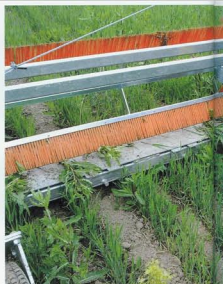
Pelkkä laiho kasvaa ryhdikkäänä, kun koneen 150 terää ovat viiltäneet jämäkät ohdakkeet poikki.
