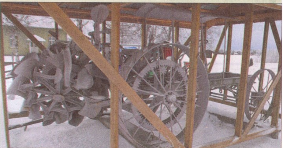
År 1913 byggde Isak Wahlstedt d.y den här dikesmaskinen som gick under namnet Autodigger. Det var en avancerad maskin på sin tid. På en dag lade den 2 000 meter färdigt dike bakom sig. Maskinen står i dag under ett tak utanför hembygdsmuseet i Västerhankmo.
