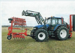
Einböck-SMS-yhdistelmä on monipuolinen ja esimerkiksi päisteissä ja kosteissa paikoissa kätevä, sillä jyrä voidaan tarvittaessa nostaa ylös. Tieajossa sivuluohkot turvautuvat.
